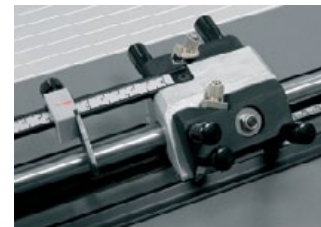
El carro central de corte dispone de dos cabezales, uno a 45° en el lado izquierdo y otro a 90° en el derecho.
