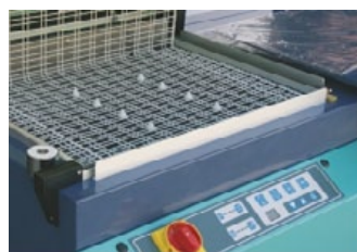
La rejilla interior se regula fácilmente dependiendo de la altura del marco.
