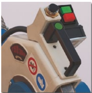
Pulsadores de arranque, parada, bloqueo neumático y pestillo de seguridad en un mismo punto.
