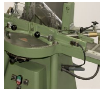
Prensos hidráulicos para la sujeción horizontal de la moldura.
