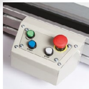
Paneles de mandos a ambos lados de la máquina. La seguridad siempre al alcance de la mano.
