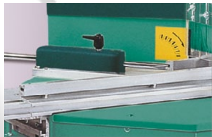
Prensos horizontales manuales para la sujeción de la moldura.
