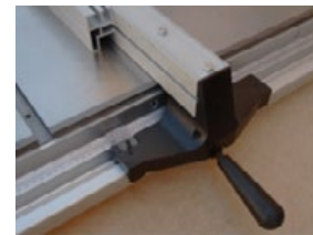
Tope lateral de medición con sistema de fijación rápido.
