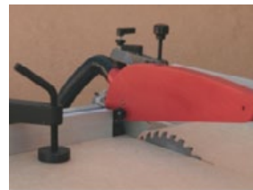
Presor mecánico del material a cortar y protector de la sierra.
