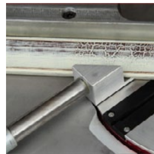
Preñores horizontales para sujeción de la moldura.
