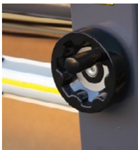
Volante para la regulación de altura de los rodillos.
