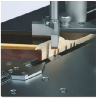
Posibilidad de clavar varias grapas tanto en sentido vertical como horizontal.
