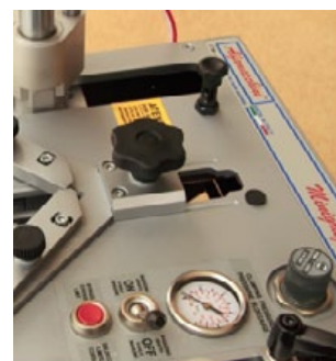
Escuadra de apoyo desplazable horizontalmente, para ajustar al ancho de la moldura.
