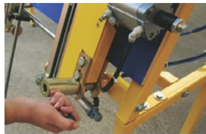
Girando la maneta inferior los topes laterales se desplazan a izquierda y derecha.
