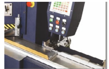
A través del ordenador, se controla rápida y fácilmente las medidas a cortar.
