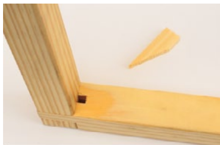
En el interior de cada esquina del bastidor hay una ranura para la colocación de la cuña de tensado.
