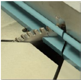
El sentido de corte de la sierra proporciona un corte limpio y perfecto.
