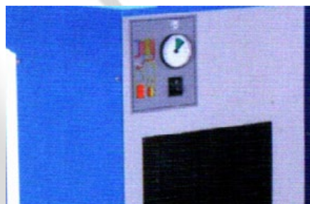
Todo en uno, secador de aire integrado, colocado en la parte superior izquierda del calderín.
