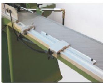
Brazo derecho con medición de 2500 mm. y doble tope de medidas.
