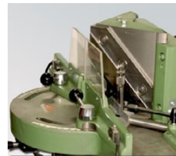
Pulsadores de seguridad para efectuar el descenso de las cuchillas.
