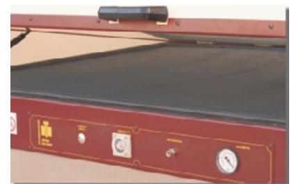
Panel de mandos con temporizador, pulsador de marcha, vacuómetro y válvula de descarga.
