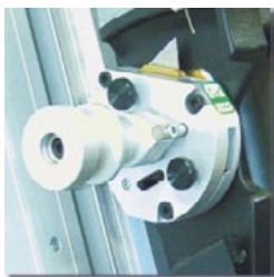
Portacuchillas giratorio multifuncional.
