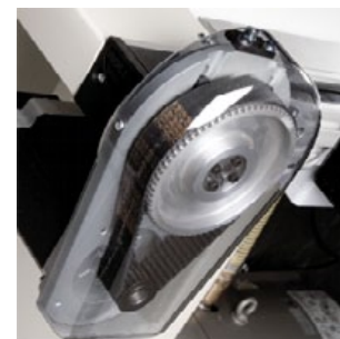
Dos robustos y potentes servomotores efectúan los desplazamientos horizontales y verticales del grupo de corte con suma precisión y rapidez.
