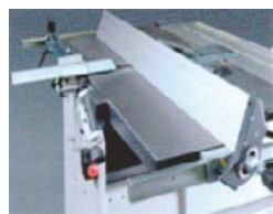
Cepilladora con mesa de 310 mm. de ancho.
