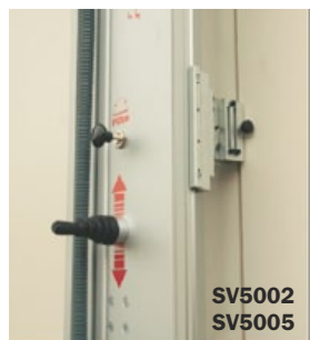
SV5002 SV5005 Accesorio opcional, Foam cut, para el corte de cartón pluma.
