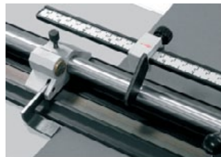
El imán embutido dentro del tope inicial, facilita el comienzo del corte de la ventana.
