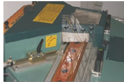
El tope de medición es abatible y discurre a través del brazo de medición.
