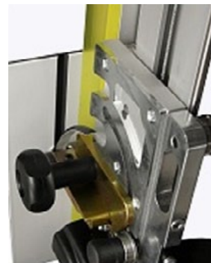
Las puntas de herramienta reemplazables se adaptan a bloques de corte de todos los tamaños.
