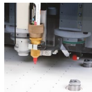
Dos cabezales de corte y uno de rotulación con regulación individual de la profundidad de corte ó marcaje.
