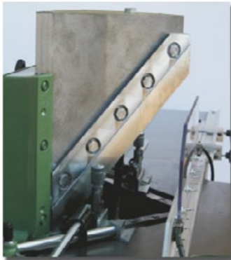
Cuchillas de acero capaces de cortar hasta 150 mm. de ancho.
