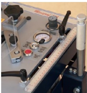
Topes de medición para colocar las grapas correctamente a lo largo de los 20 cms. de recorrido.
