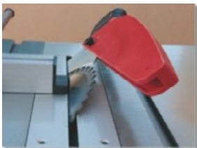
Sierra de corte inclinable de 0 a 45 grados.
