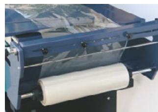
El rollo de retráctil se encuentra situado en el lateral derecho.
