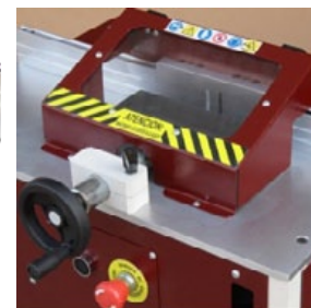
Prensor horizontal manual fácilmente ajustable a la moldura.
