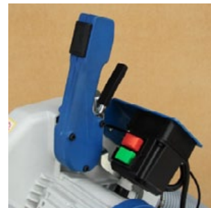
Empuñadura con embrague, freno motor e interruptores de parada y puesta en marcha.
