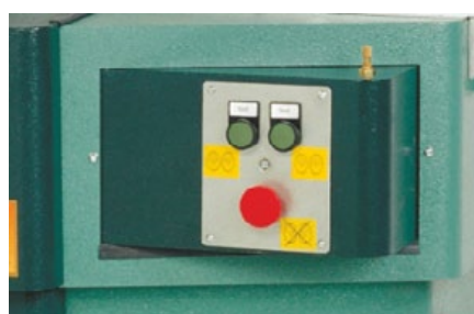
Panel de mandos con interruptores independientes para cada motor y parada de emergencia.
