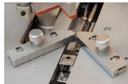
Escuadra de apoyo regulable y boquilla de salida de grapas, fácil de cambiar.
