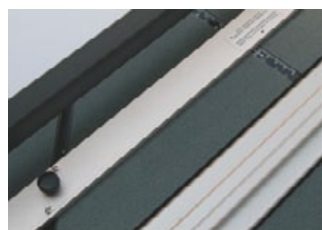
El tope lateral para el corte del ancho de la ventana se desliza a través de dos guías a 45°.
