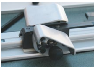
El bloque del portacuchillas incorpora la cuchilla de corte recto y la de corte a bisel.
