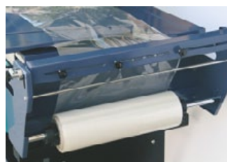
El rollo de retráctil se encuentra en el lateral derecho.
