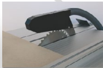
Sierra de corte debidamente protegida según normativa.
