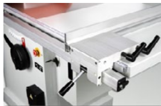
Barra de medición con tope de medidas.
