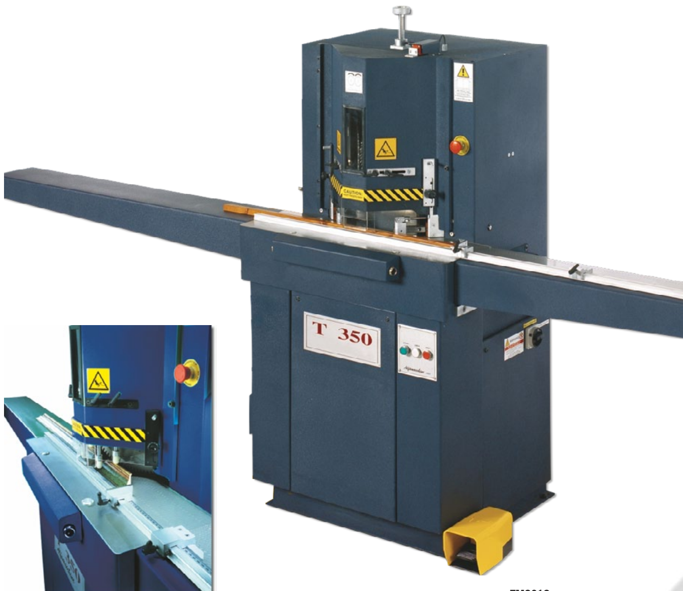
Dos prensos verticales neumáticos sujetan la moldura a ambos lados de las sierras de corte.
