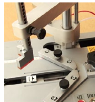
Escuadra de apoyo regulable y prensor vertical con ajuste rápido en altura.
