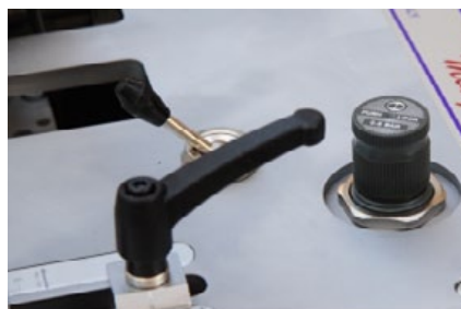
Regulador de presión y topes de posición colocados en la parte superior de la máquina.
