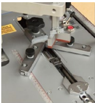
Escuadra de apoyo regulable, prensor vertical y mordaza horizontal.
