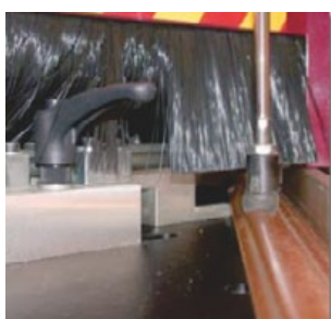
Los prensos verticales se desplazan fácilmente hacia adelante y hacia atrás.
