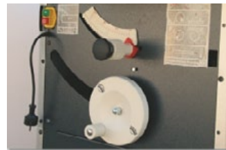
La sierra de corte puede subir, bajar e inclinarse hasta 45 grados.
