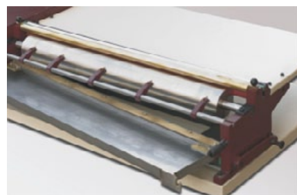
Depósito de cola fácilmente extraíble para su posterior limpieza.
