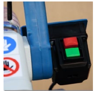
Pulsadores de arranque, parada, bloqueo neumático y pulsador de seguridad en un mismo punto.
