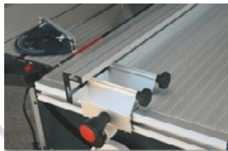
Barra tope con medición al lado derecho.
