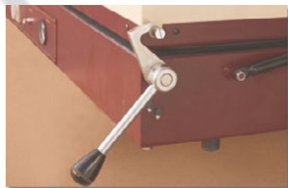
Nuevo sistema de cierre accionado en el lado derecho de la máquina.
