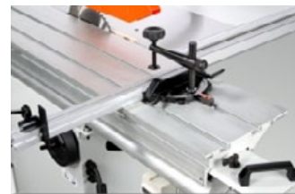
Sierra de corte debidamente protegida según normativa.
