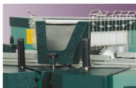
Palancas manuales para el avance de las sierras de corte y protección integral en toda la zona de corte.
