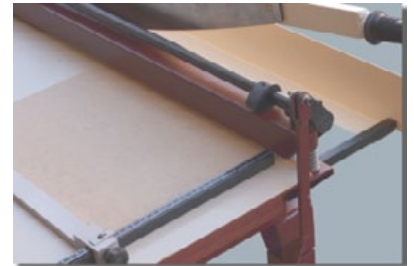
El tope izquierdo permite cortar perfectamente a escuadra.
