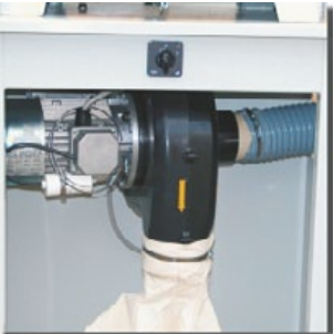
Aspiración incorporada en el interior del mueble soporte.
