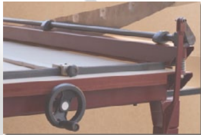
A través del volante el tope derecho se desplaza fácilmente.
