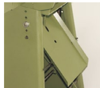
Bandeja posterior para la salida del desperdicio de la moldura cortada.
