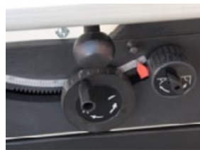
Volantes de regulación de altura e inclinación de la sierra.
