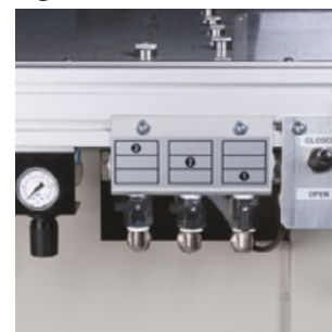
Mesa con aspiración dividida en seis areas independientes subdivididas a su vez en dos zonas de trabajo.
