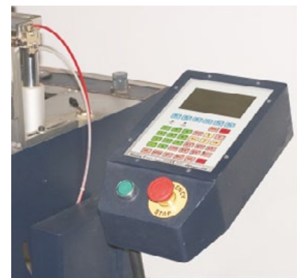
A través del teclado es posible controlar hasta 4.000 programas distintos de clavado.
