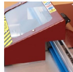
El nuevo protector integral cubre completamente la zona de corte.
