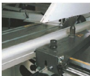
Soporte guía paralela en fundición.
