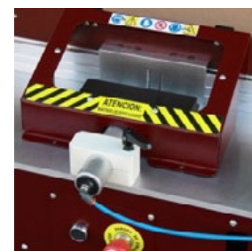
El prensor neumático avanza y sujeta fuertemente la moldura.
