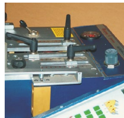
Los tres toques de producción determinan las posiciones donde se clavará la grapa.
