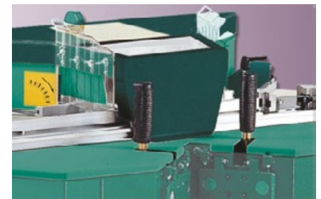
Empuñaduras para el deslizamiento horizontal de los discos de corte.
