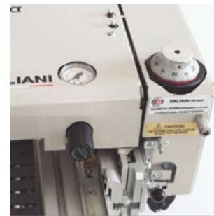
La máquina está equipada con un robusto cabezal de corte a 45° para efectuar tanto el corte interior como el exterior del passe-partout.
