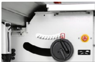
La sierra de corte puede inclinarse 45 grados.
