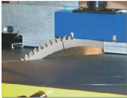
Sierra de widia de 350 mm. de diámetro con gran capacidad de corte.
