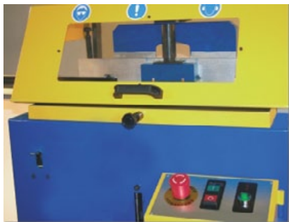
Pantalla integral de protección con pulsador de parada de emergencia.
