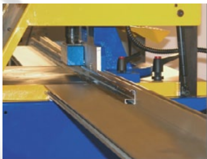
Prensor vertical de sujeción del aluminio y brazo de medidas de 1500 mm.
