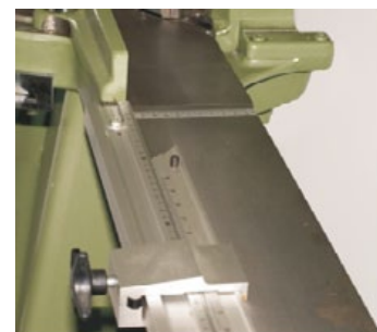
Brazo derecho con regla de medición de 1.500 mm. y tope de medidas.
