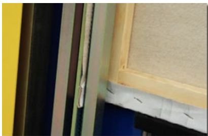
Pinzas laterales de acero que permiten una sujeción total de la tela antes de tensarla.
