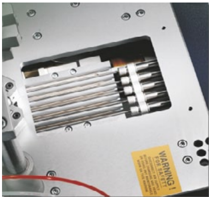
Vista parcial del cargador múltiple, que incluye cargadores para la grapa de 5, 7, 10, 12 y 15 mm.
