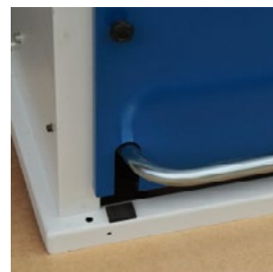
Pedal inferior para el accionamiento de los preñores.
