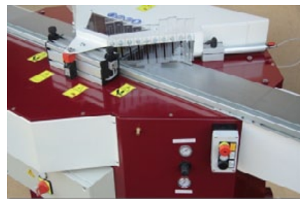
Interruptor general, pulsador de puesta en marcha y parada de emergencia en el frontal.
