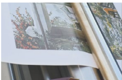
Encolado de láminas o cualquier tipo de papel de hasta 720 mm. de ancho.
