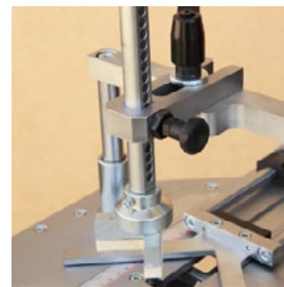
Prensor vertical imantado en escuadra y redondo con un rápido sistema de ajuste vertical.
