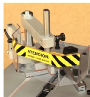
Protector de metacrilato en la zona del prensor vertical de sujeción de la moldura.
