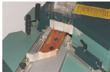
Plano diagramado de medición al lado derecho y tope abatible de medidas.
