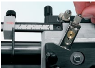
El portacuchillas permite un rápido cambio de cuchilla así como un fácil sistema de regulación.
