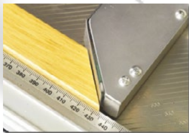
Un micro-interruptor colocado en el tope indica cuando esta ha llegado al mismo.
