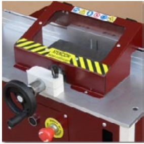
Preensor horizontal manual fácilmente ajustable a la moldura.
