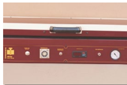
Panel de mandos con temporizador, pulsador de puesta en marcha, termostato, vacuómetro y válvula de descarga.
