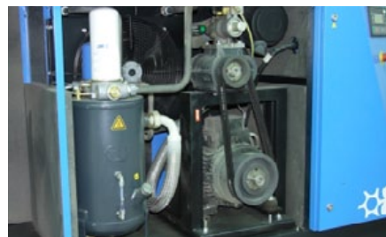
Filtros de aire y aceite de fácil acceso desmontando los paneles laterales.
