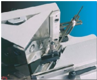
Sistema de medición rayado sobre la placa del brazo derecho.
