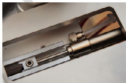
El empujador horizontal de la grapa es neumático, rápido y fácil de manejar.
