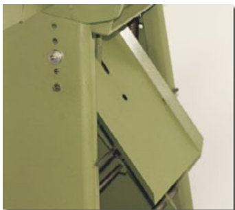
Bandeja posterior para la salida del desperdicio de la moldura cortada.
