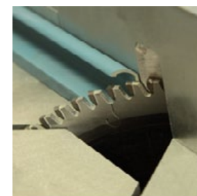
El disco sube manualmente hasta completar la operación de corte.
