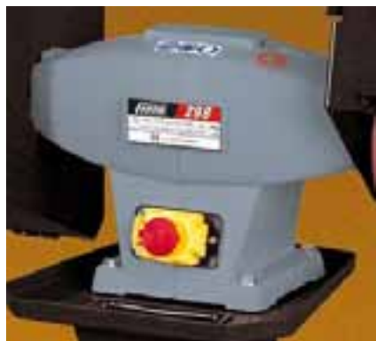
Interruptor y pulsador fungiforme con posibilidad de bloqueo.
