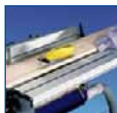
Sierra circular con diámetro de 200 mm. y guía angulada a 45°.
