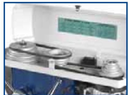
Tapa superior con micro-interruptor de seguridad
