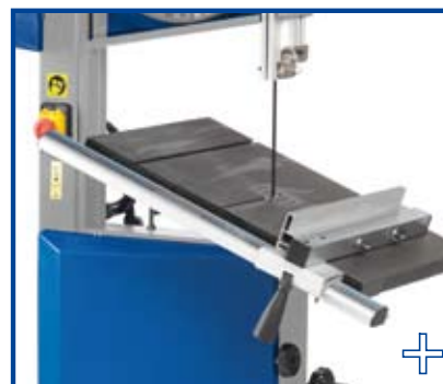
Mesa de trabajo en aluminio, inclinable a 45°. Altura de corte 230 mm.
