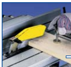
Guía móvil con goniómetro y mordaza de sujeción
