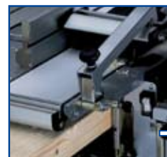
Ancho de regruessado hasta 154 mm. y 100 mm de altura
