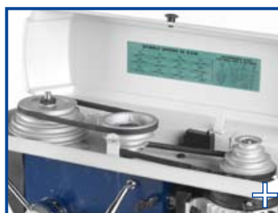
Tapa superior con micro-interruptor de seguridad
