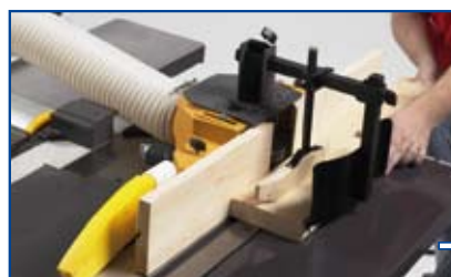
Cepilladora y regresadora con mesas de hierro fundido
