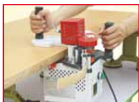
Anleimung an gerade Kanten straight edge bending
