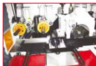
4. und 5. Arbeitsspindel speziell für Profilarbeiten konzipiert. NEU: beidseitig angetriebener und schaltbarer Materialauszug
