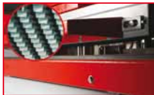
Lamellenband zum Werkstücktransport multi-fin work piece feeder
