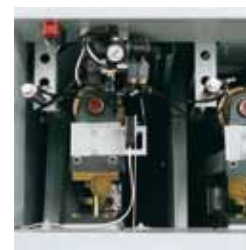
Schutzeinrichtung bei Schleifbandriss broken belt protector
