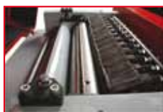
Gliederanpressbalken serienmäßig structured pressure bar standard
