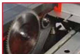
Vorritzer mit eigenem Motor independently powered scoring unit
