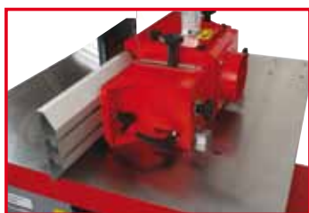
präzis einstellbare Fräshaube mit Querführung und Feineinstellung precisely adjustable hood with crossway guide
