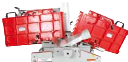
links in Arbeitsrichtung aufklappbare Abrichttische planing tables folding to left side
