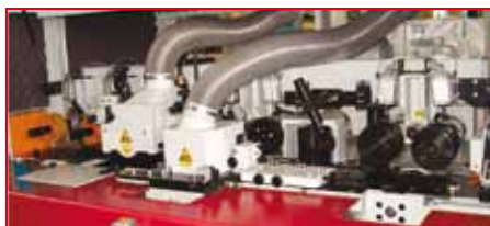
robuster, massiver und schwingungsarmer Aufbau in Stahl-Graugusskonstruktion
