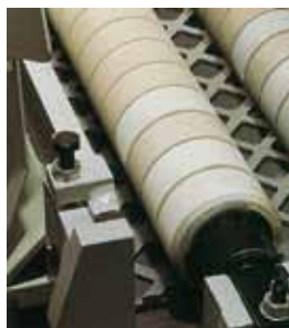
Anpressrollen mit Rückschlagschutz backstop roller avoid rebounding of workpiece
