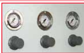
pneumatisches Andrucksystem für jede Einzugs- walze, individuell vom Bedienplatz regulierbar
