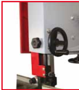
Führung mittels Handrad verstellbar guidance adjustable via hand wheel
