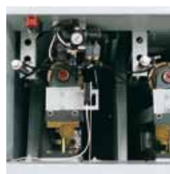
Schutzeinrichtung bei Schleifbandriss broken belt protector
