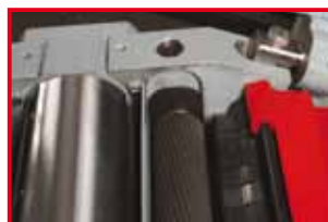
spiralverzahnte Einzugswalze spiral-toothed infeed roller
