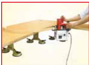
Anleimungen an Schweifungen / Radien curve edge bending
