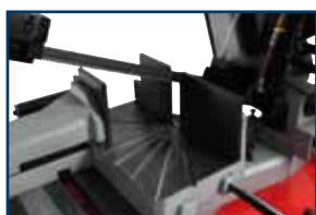
großer Schwenkbereich (+45°/-60°) performs mitre cuts (+45°/-60°)
