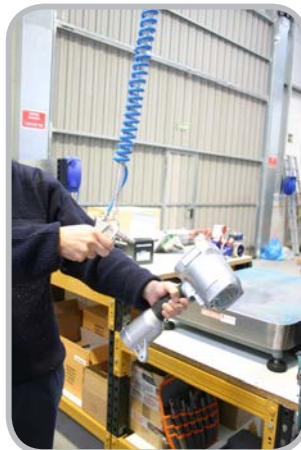
LAR-034516 PISTOLA DE SOPLADO CON CUERPO DE ALUMINIO CON REGULACIÓN DE CAUDAL DE AIRE Y ESPIRAL DE POLIURETANO DE Ø 5 mm x 8 mm x 6 metros DE LONGITUD. CON MUELLE TENSOR INCORPORADO Y GANCHO DE SUJECCIÓN. IDÓNEO PARA CADENAS DE MONTAJE ROSCA 1/4
