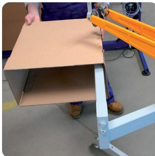
GRAPADORAS ESTACIONARIA: brindan mayor eficiencia porque son operadas por una palanca de pie o una válvula neumática que permite al operador usar ambas manos al formar la bandeja
